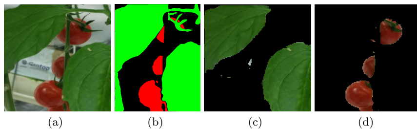
Fig. 15. Resultado del proceso de segmentación semántica ejemplo 3. a) Imagen Original. b) máscara de la imagen. c) Segmentación semántica de hojas. d) Segmentación semántica de frutos.
